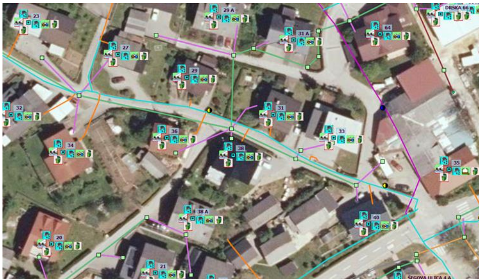
Slika 3: Prikaz odjemnih mest s storitvami v prostoru in javno omrežje vodovoda ter kanalizacije
